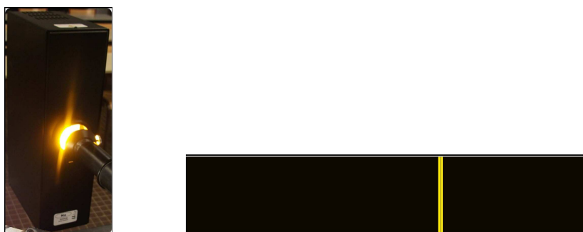
FIGURE 4 – Une lampe à décharge à vapeur de sodium et son spectre d'émission
