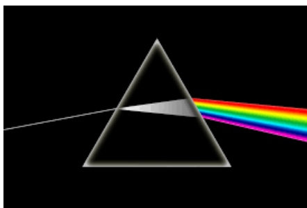
Figure 8 – Dispersion de la lumière par un prisme
