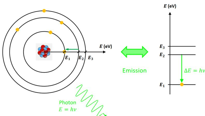
Figure 16.3 – Schéma décrivant le processus d'émission d'un photon par un atome
