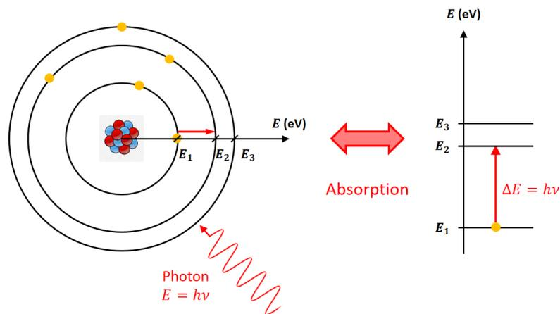
Figure 16.2 – Schéma décrivant le processus d'absorption d'un photon par un atome
