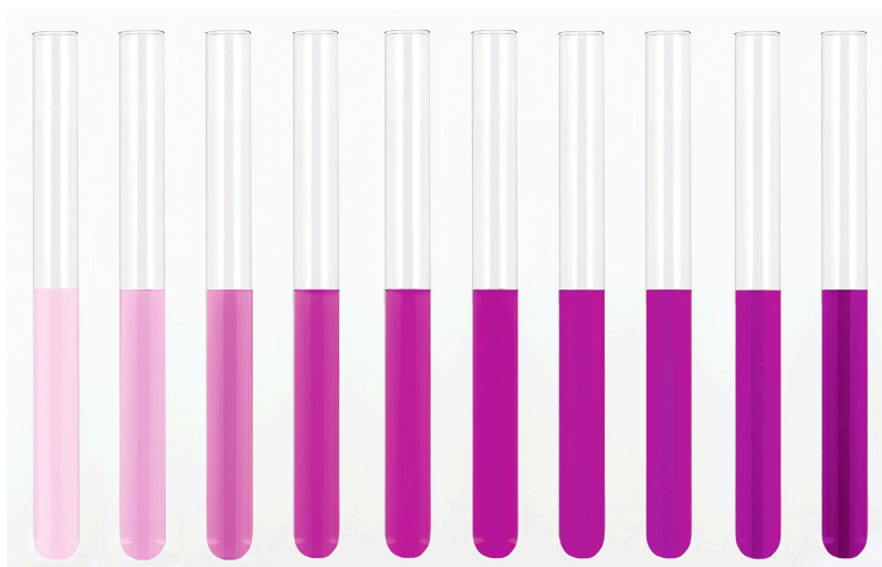
Figure 2.3 – Exemple de gamme étalon pour une solution de permanganate de potassium ( source ).
